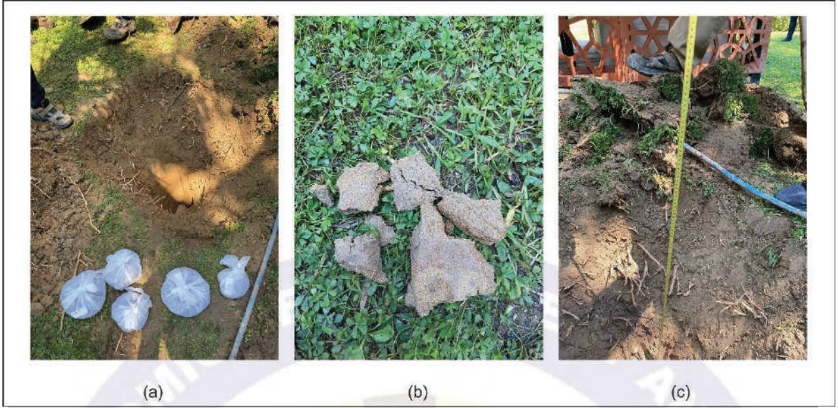
Şekil 6. (a) Muayene çukur kazısı ve örnek alımı, (b) Kumlu, Siltli, killi zemin örneği, (c) Toprak dolgusu ardından kumlu, siltli killi zemine ulaşılan derinlik.
