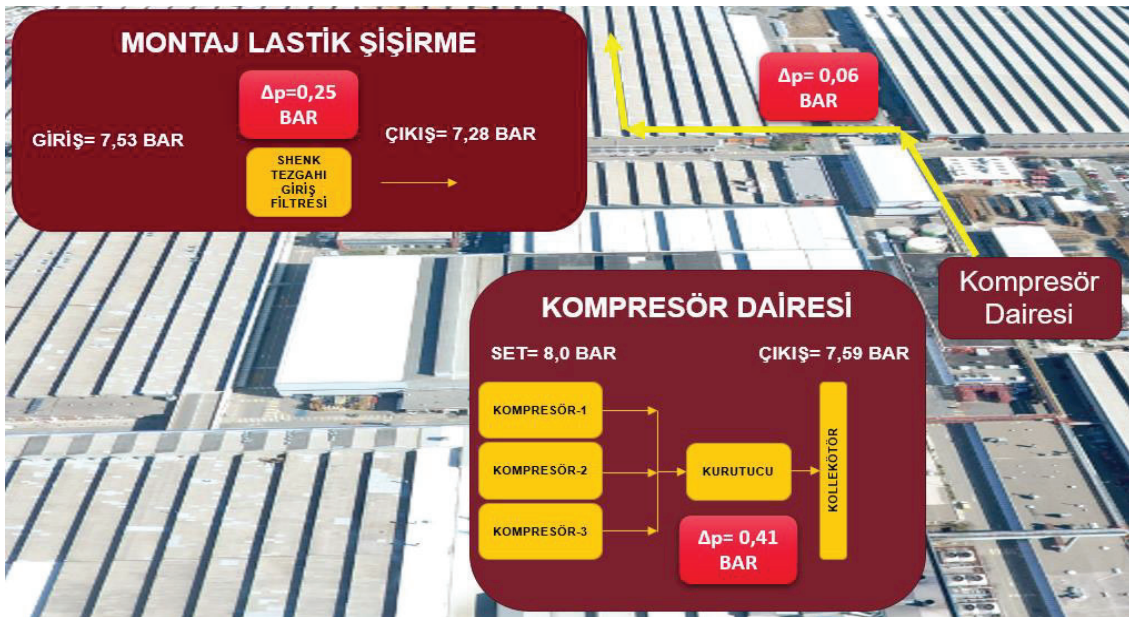
Şekil 5: Kompresör dairesi ile montaj lastik şişirme üretim hattı arasında yapılan basınç ölçümleri ve kayıp değerleri
