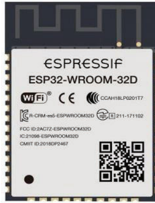
Şekil 4. ESP32-WROOM-32D Kablosuz mikrodenetleyici modülü.
